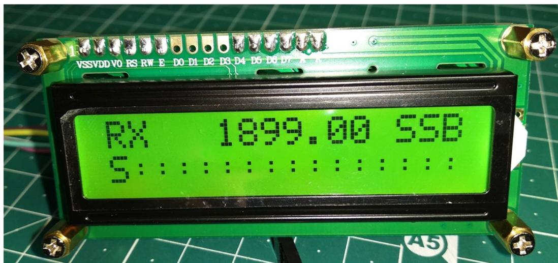
**Синтезатор частот «Mini LCD VFO» HF + 50 МГц
