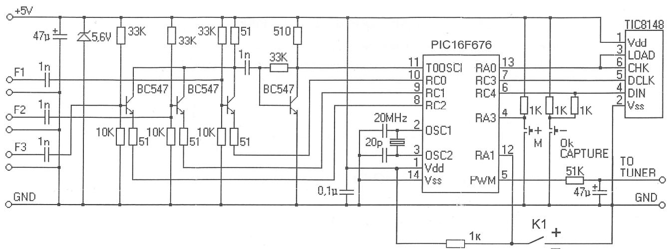
Рис.1 Принципиальная схема шкалы.
