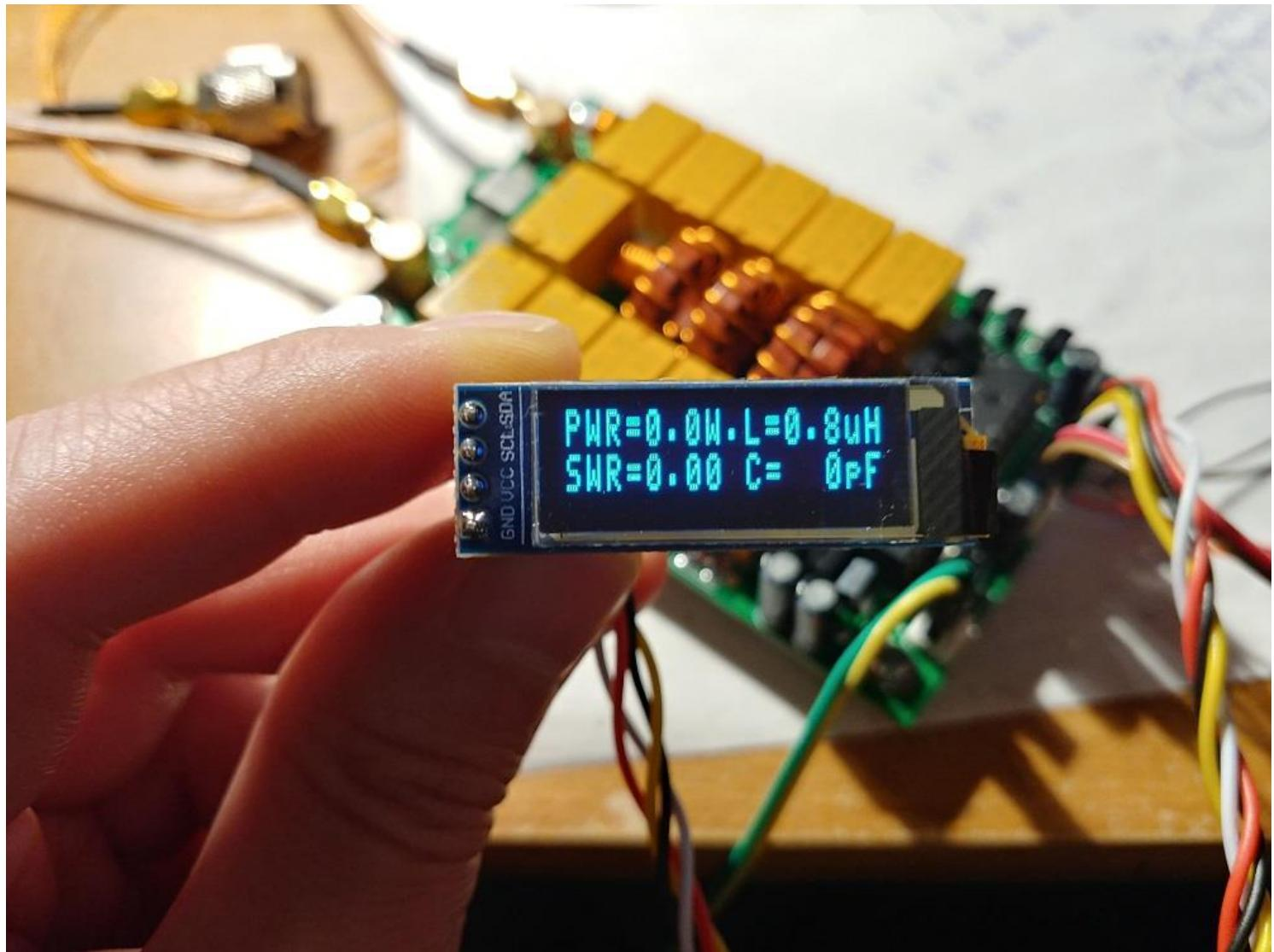
Индикация на 0.91 128\*32 дисплее выглядит, как и на обычном 1602 дисплее, имея при этом крохотные размеры.
