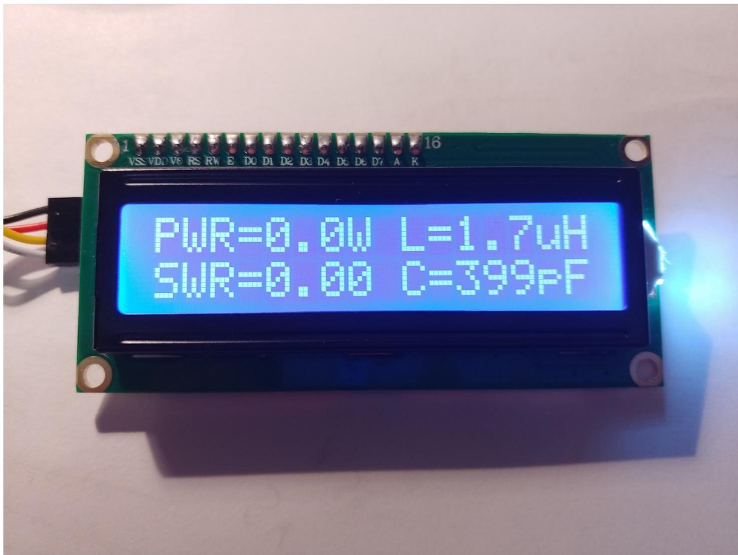
В левой части индикатора отображается проходная мощность и КСВ. Используется режим пикового детектора, что позволяет точно мерить мощность сигнала передатчика при использовании различных видов модуляции.
