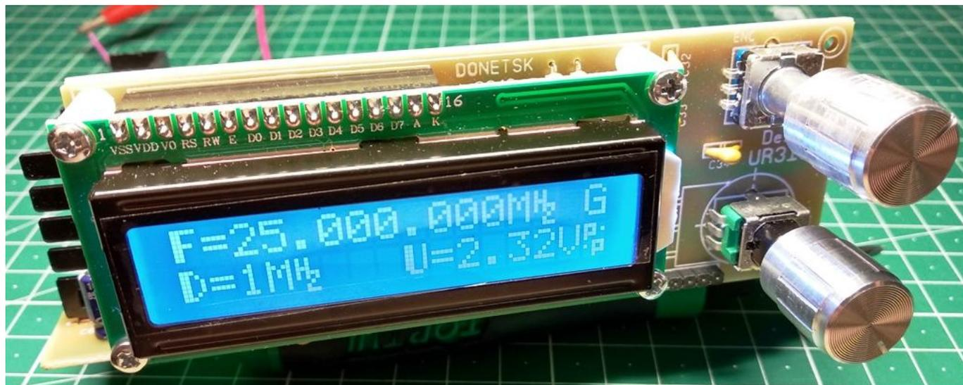
**Набор для сборки генератора (GEN) синусоидальных сигналов 1 Гц - 40 МГц с режимом генератора качающейся частоты (ГКЧ/WOB), дополнительным выходом пилообразного напряжения для синхронизации осциллографа, а также выходом 0/5 В прямоугольных импульсов с частотой качания генератора. Данное устройство разработал польский радиолюбитель Adam Sobczyk (SQ5RWQ). Данная конструкция была опубликована в журнале ELEKTRONIKA PRAKTYCZNA.**
