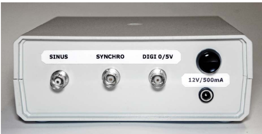
Fotografia 16. Przykładowe wykonanie i opis tylnego panelu generatora
