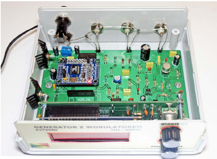
Fotografia 14. Widok zmontowanego generatora od przodu
