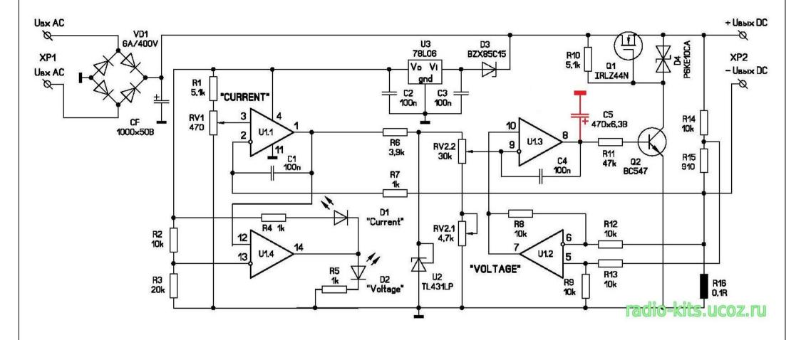
Примечание: конденсатор С5 установить навесным монтажом под печатной платой.
