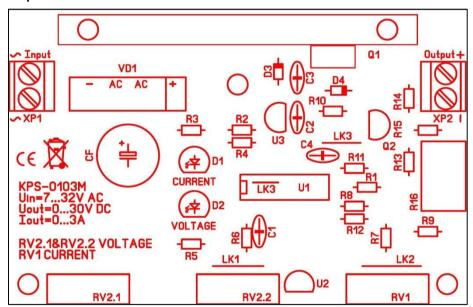
На печатной плате предусмотрены пять отверстий диаметром 3,2 мм. Два из них в верхней части платы для крепления радиатора, а остальные три для крепления самой платы в корпусе блока питания. Радиатор необходимо выбрать с площадью поверхности не менее 300 см кв. Транзистор Q1 необходимо закрепить, при необходимости, с применеием изолирующих теплопроводящих подложек. Переменные резисторы RV2.1, RV2.2 и RV1 можно закрепить на передней панели блока питания непосредственно при помощи штатных гаек.
