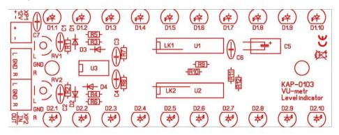
На рисунке представлен вид на печатную плату со стороны установки комонентов, при этом следует обратить вниманиена то, что микросхема U2 устанавливается с обратной стороны платы!
