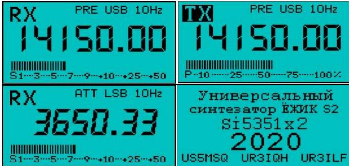
**Перекрытие рабочих частот** сплошное от 0,1 до 30 МГц при условии, что в установках включены все 9 диапазонов и разбито на 9 диапазонов с такими граничными частотами:
