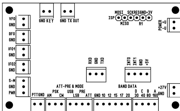
Типовая схема подключения синтезатора Ёжик-S2M к трансиверу с релейной коммутацией:
