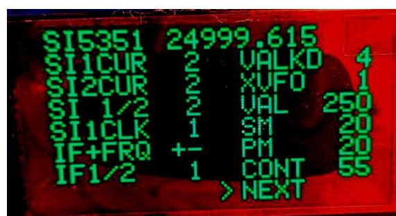
**SI5351** - калибровка тактовой частоты Si5351. Подключить частотомер к разъёму VFO и вращая энкодер выставить на выходе частоту ровно 25000.000
